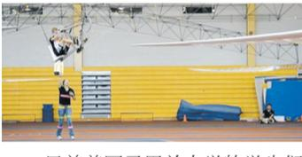
日前美国马里兰州的学生们制造出以脚踏板为动力的“人力直升机”,并使其成功升空至2.5米的高度。据报道,这种直升机有4个巨大的机翼,以脚踏和手摇作为动力。驾驶员只要坐在驾驶座上,不断地手摇手柄、脚踩踏板,就可以使直升机升空。这架直升机只要能离开地面65秒,并升空至3米,就可获得25万美元奖励。 郑芳
