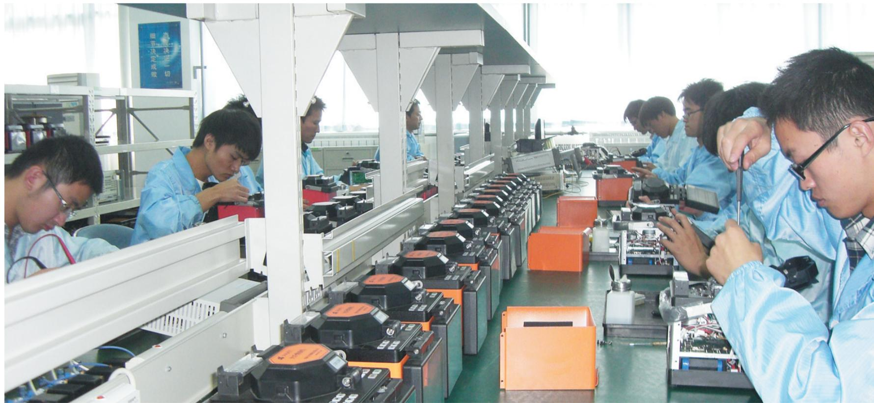
光纤熔接机是中电科41所自主创新产品,图为科技人员正在对即将出厂的光纤熔接机做最后的性能检测。
