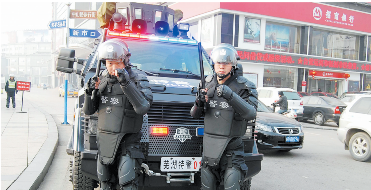
近日,一辆反恐突击装甲车在芜湖市区街头震撼亮相,这也是反恐突击装甲车首次“登陆”江城。据悉,该反恐突击装甲车采用防弹钢板与原车整体焊接结构,全车六面防弹性能优异,具有很强的抗冲击能力。它的内部配备了可对外进行监控的摄像系统和专用高效特种探照灯,在夜间也可以清楚地对外部进行监控。
