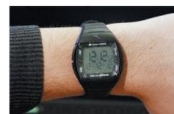
印度强奸案高发引起广泛关注,不少人开动脑筋提出防范措施。美国媒体报道,印度一科技公司最近设计一种带全球定位系统的手表,戴着该表的妇女一旦遇险可按下开关向附近警局或家人报警并显示所在位置。手表上还装有摄像头,可以进行一个半小时的录影。 史磊
