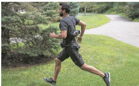
美国和韩国研究人员最新开发出一款便携式“机器人短裤”,这种辅助设备可以让穿戴者行走和跑步更加轻松。研究人员介绍,这种柔性“机器人短裤”重约5千克,包括驱动系统以及将腰部和大腿包裹起来的织物。测试显示,该设备可识别穿戴者的步态,并提供相应协助,使其行走时的能耗降低9.3%,跑步时的能耗降低4%。 □ 据《都市快报》
