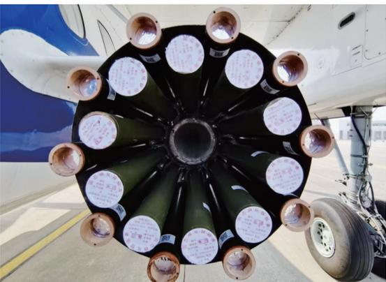
“新舟60”增雨飞机机翼上已装满焰条
