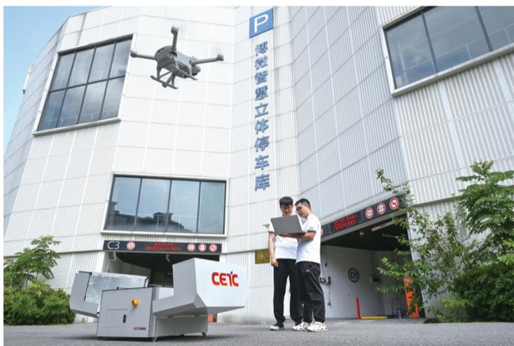
近日,安徽博微联控科技有限公司发布了第一代无人机巡检一体化平台,该平台由无人机、全自动机场及管理平台三大系统构成,主要用于智慧停车、高速监视等智慧交通相关服务,使用者可通过操控管理平台远程实现无人机任务下达,控制无人机完成动作,实现道路监视、车辆监控与计费等功能。
